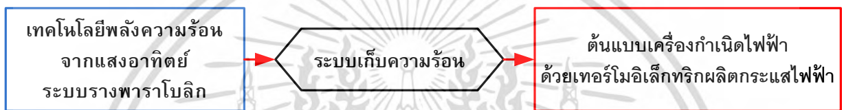
รูปที่ 1.2 แผนผังต้นแบบเทอร์โมอิเล็กทริกขนาดเล็กแบบผลิตไฟฟ้าจากความร้อนของการรวมแสงอาทิตย์ร่วมกับสารเก็บกักความร้อน
