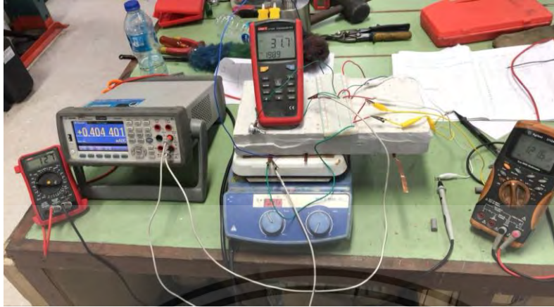
รูปที่ 3.6 ผลการทดสอบแท่งโมดูลเทอร์โมอิเล็กทริกเบื้องต้นในห้องปฏิบัติการ
